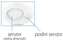
› Senzor prisutnosti\* usmjerava zrak dalje od svih detektiranih osoba u prostoriji.
